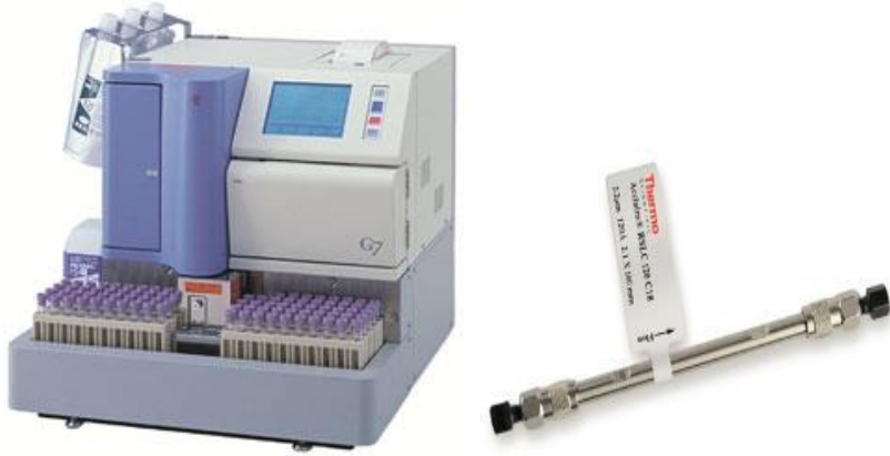
Figure 6. De gauche à droite : G7 de Tosoh Biosciences avec les éluants 1,2 et 3 ; la colonne échangeuse d'ions
